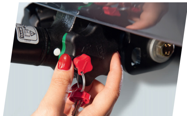
Kugelhals lösen: Drehrad herausziehen und leicht nach rechts drehen
